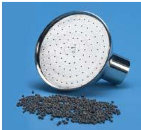
Le compteur de semence-Aspiration est un appareil pratique qui se charge du travail malaisé et long, c'est-à-dire de compter les graines de semence. Il est particulièrement adapté pour des semences aux formes régulières et lisses comme les céréales, brassicale et trifolium.
