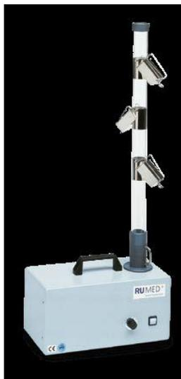
Le trieur par montée permet de trier entre les graines de semence légères et lourdes ou autres corps vides. La semence est mise dans le cylindre de plexiglas du trieur. Le moteur provoque un courant d'air dans le cylindre, les semences sont prises par le souffle et retombent selon leur taille et poids dans l'un des trois gobelets qui se trouvent le long du cylindre. La semence légère se trouve dans le gobelet du haut et la semence lourde dans celui du bas.
