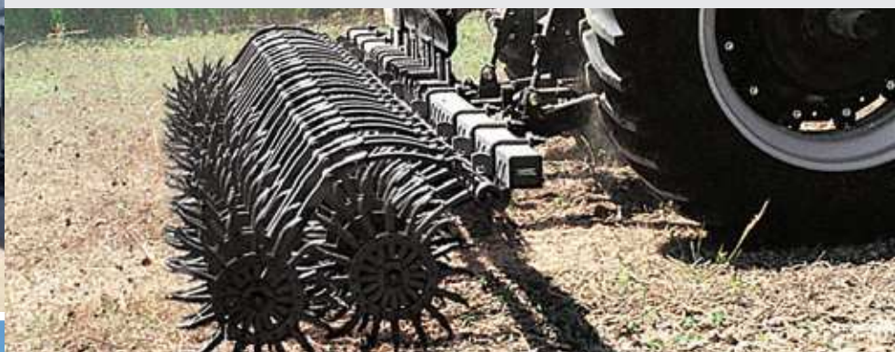
3400/3500 HOUE ROTATIVE POUR LABOUR MINIMAL Idéal pour les briser les croustes à teneurs élevées en résidus
