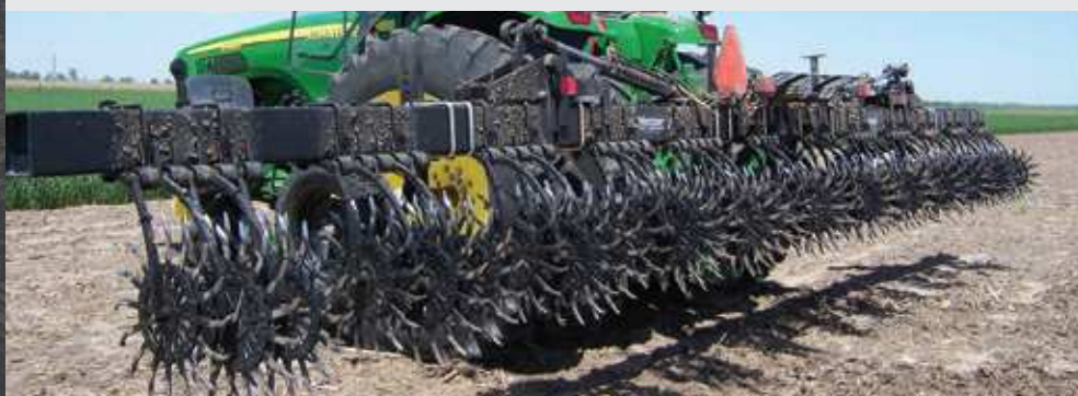
3700 HOUE ROTATIVE POUR CULTURE SUR BILLON Brise la croûte du sol tout en labourant sur le dessus des billons et des bandes
