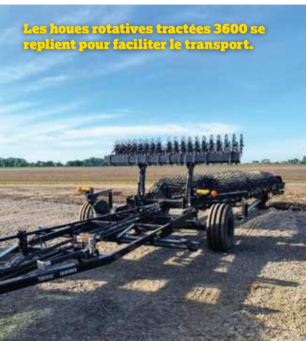
3600 HOUE ROTATIVE TRACTÉE Outil de conservation des semences à faible largeur de transport
