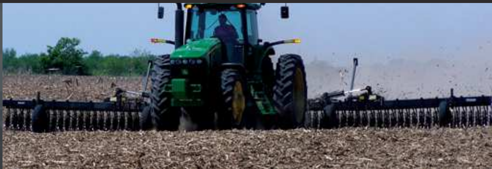
3400/3500 HOUE ROTATIVE CONVENTIONNELLE Brise la croûte du sol pour favoriser les plants émergents
