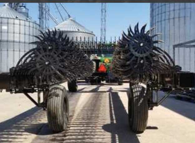
Les houes rotatives tractées 3600 se replient pour faciliter le transport.
