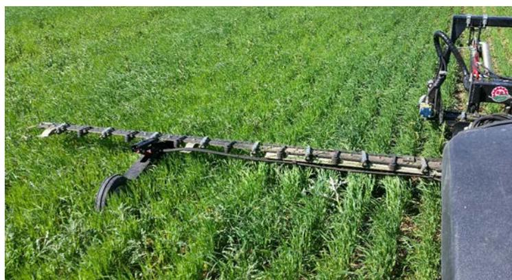
Ecimage avec roue jauge à hauteur réglable hydrauliquement
